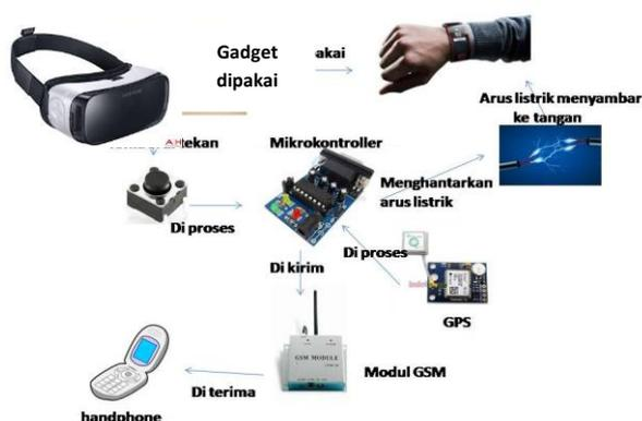
**Gambar.3 Gambar Perancangan Sistem**
